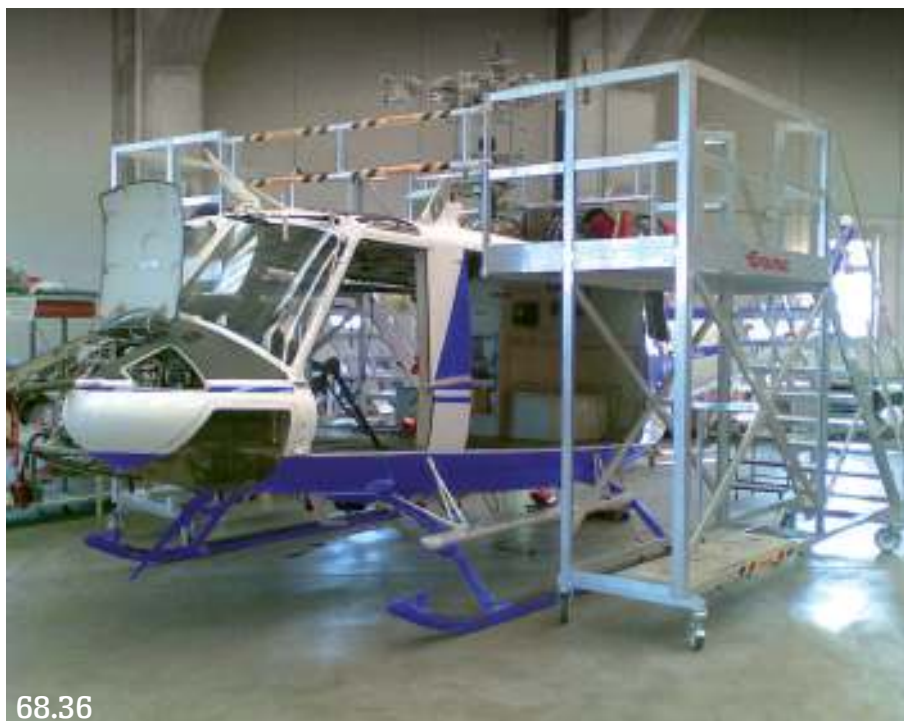
Escalera acceso trampilla frontal para aviones
